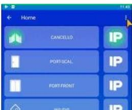
A questo punto è possibile gestire il proprio dispositivo secondo le proprie necessità. Sulla parte **sinistra** sono elencate le **uscite**, sulla parte **destra** gli **ingressi**. **(DEFAULT)**
